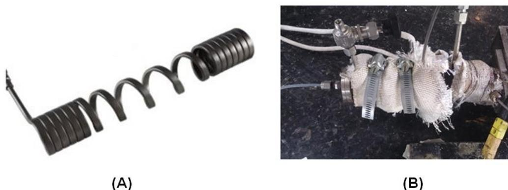
A Figura 4.29 (A) mostra a resistência, da marca Watternes, com 400 W de potência e perfil achatado de 1×4 mm e 60 cm de comprimento. A temperatura foi mantida constante por um controlador de temperatura Novus N480D.
