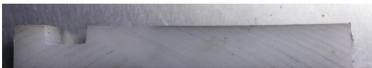
Figura 5.7 - Fotografias do um teste de queima de HDPE, com um sulco com  $H_2O_2$  (85%).
