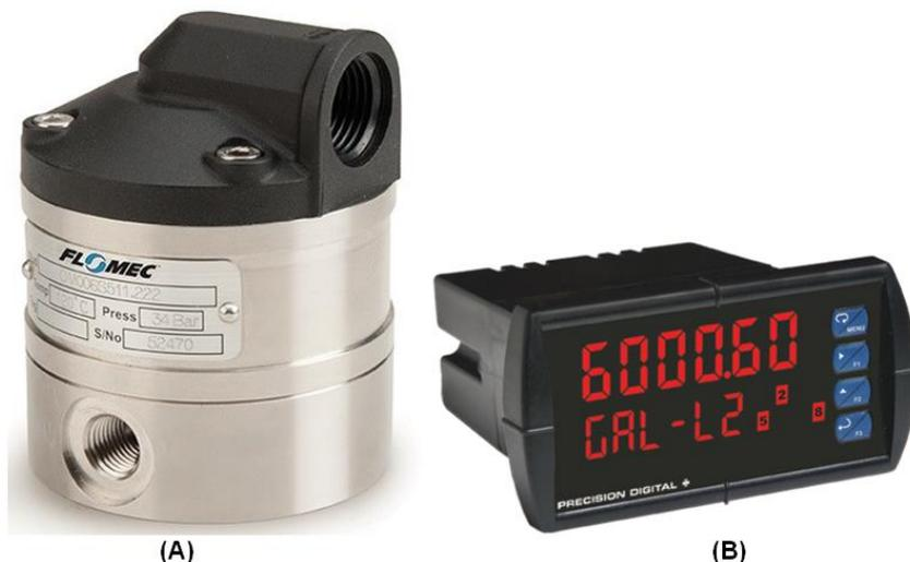
Este medidor de vazão funciona mediante um sistema de engrenagens com um pequeno ímã, como mostrados na Figura 4.25, que por efeito Hall registram pulsos elétricos em seu circuito interno que é conectado ao *datalogger* através do contador de pulsos (PD6300).
