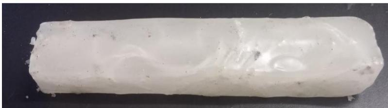
Na Figura 5.30 vê-se o grão de Parafina + 1% algodão, queimando com oxigênio proveniente da decomposição catalítica de solução de peróxido de hidrogênio em concentração de 90%, com as condições de operação mostradas na Tabela 5.9.
