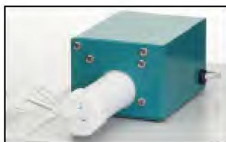
Figura 5.4 – Supressor químico utilizado na análise de ânions (Metrohm, 2011).
