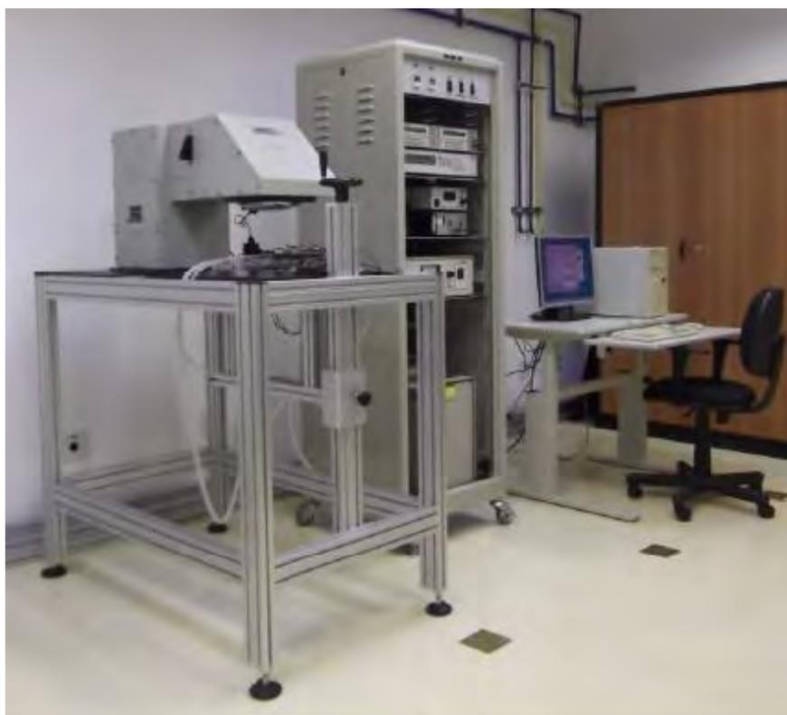
Figura 3.37 - Sistema de curva I x V.
