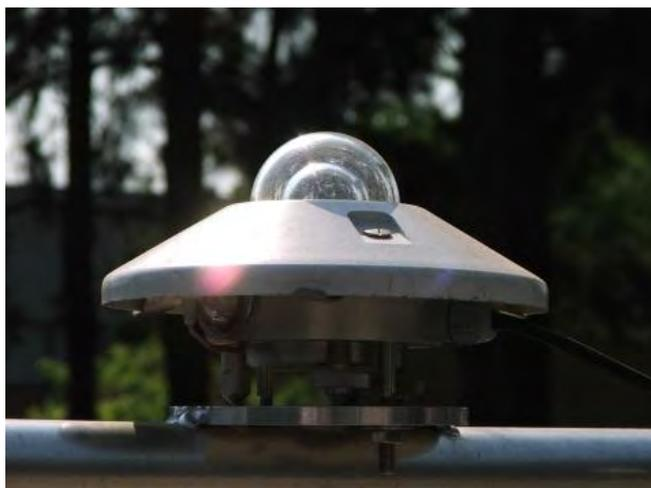
Figura 3.28 - Radiômetro termoeletrico, modelo CM11.
