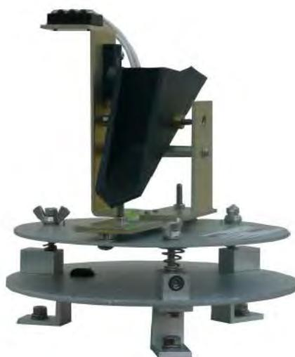
Figura 3.26 - Detalhe do princípio de funcionamento de um pluviômetro.
