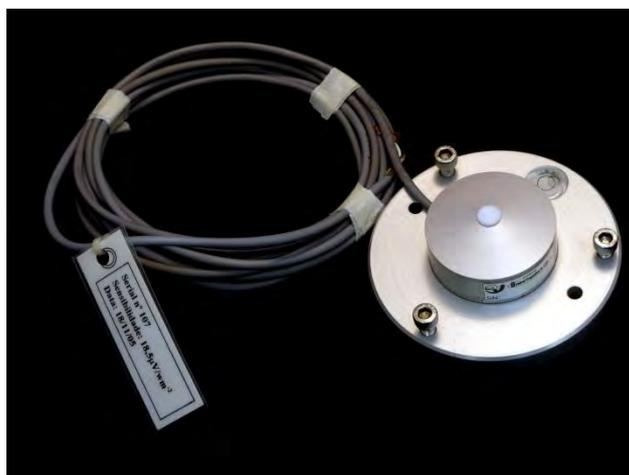
Figura 3.29 - Protótipo de radiômetro PAR, modelo LAS 107.
