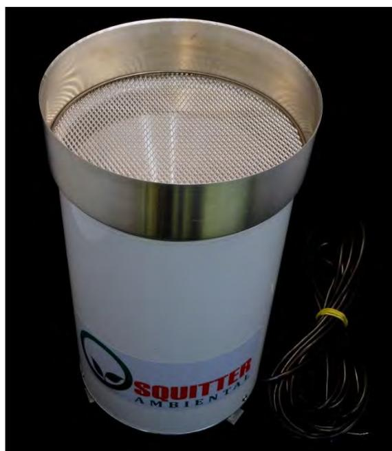
Figura 3.27 - Pluviômetro utilizado nas unidades.
