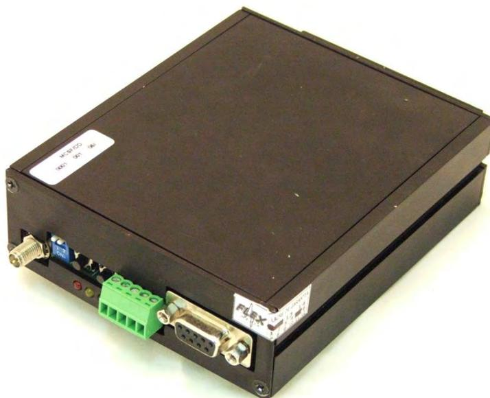
Figura 3.35 - Transceptor RS232 de fabricação da FlexMedia.
