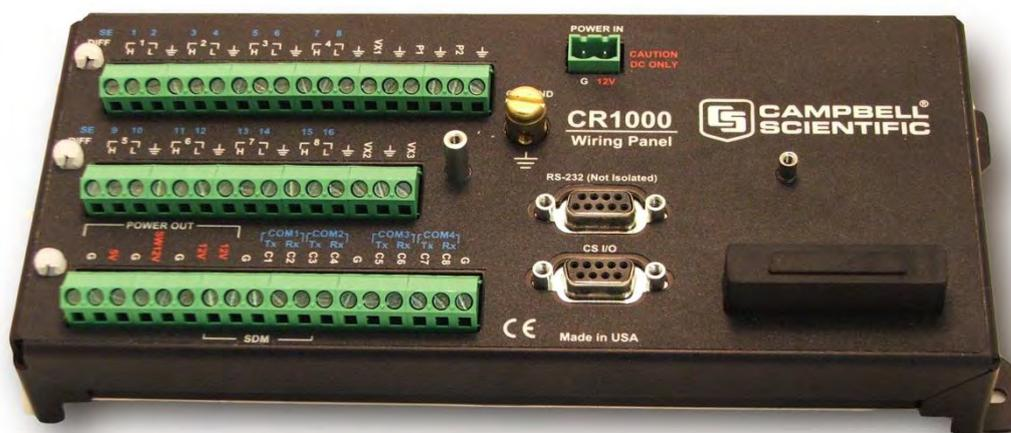
Figura 3.32 - Datalogger CR1000 de fabricação da Campbell Sci.
