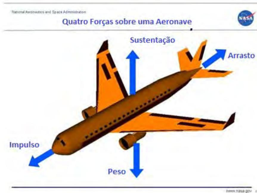
**Figura 2.2:** Esquema mostrando o balanço de forças que atuam sobre uma aeronave em voo.
