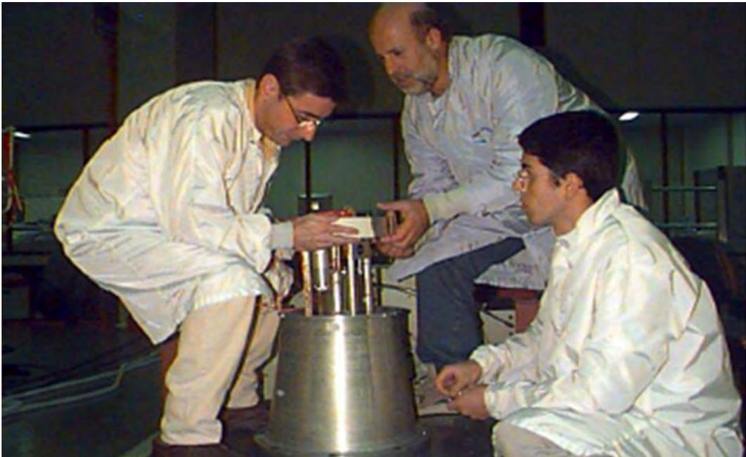
Figura 3.8 - Teste de vibração / aceitação efetuado no LIT/INPE.
