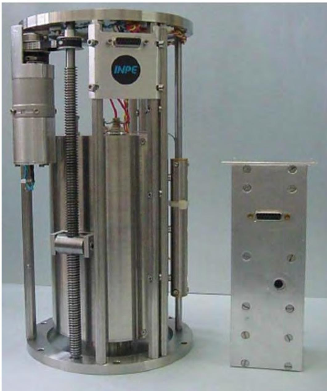
Figura 3.7 - Modelo de vôo do forno de solidificação multiusuário e módulo de controle.
