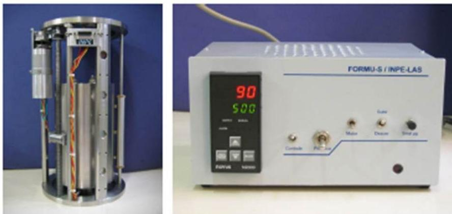
Figura 3.3 - Forno e controlador construídos para a UFPE.
