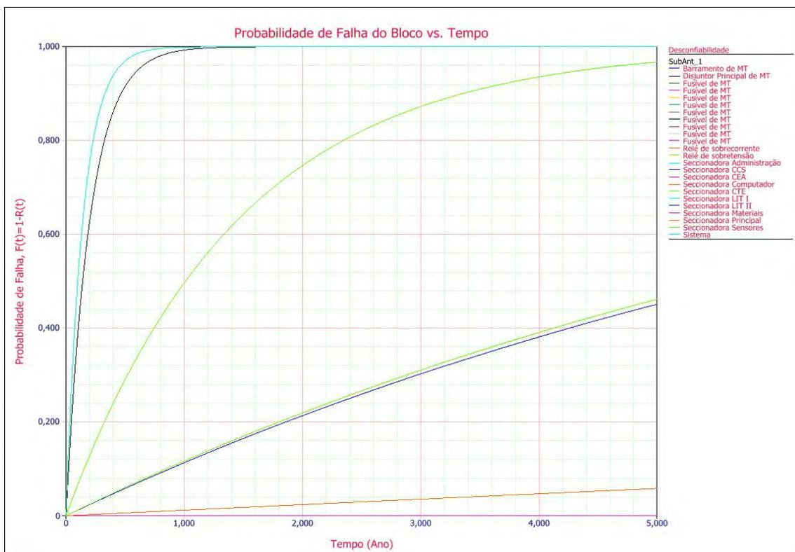
Figura 5.11 - Probabilidade de falhas dos blocos da subestação antiga
