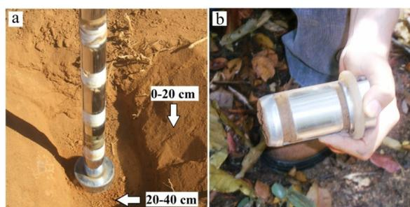
Figura 4.5 - Retirada de amostras para determinação das análises físicas dos solos, em duas profundidades (0-20 e 20-40 cm) utilizando um trado tipo TAI (a). Exemplo de solo coletado com anel volumétrico (b).
