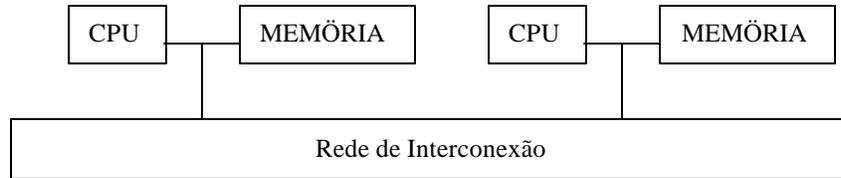
Fig. 2.3 - Esquema genérico para sistemas paralelos de memória distribuída.
