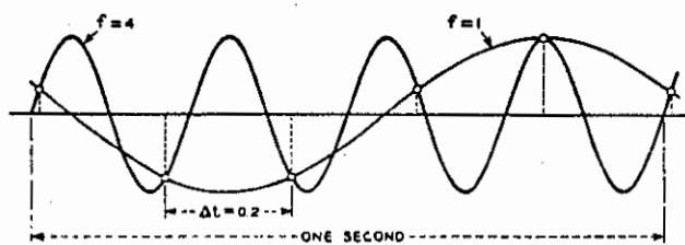
Fig. 2.2 - Efeito de sobreposição ("aliasing") resultante de baixa taxa de amostragem. Círculos pequenos indicam pontos amostrados. Adaptado de Blackman e Tukey (1958), pp 31.
