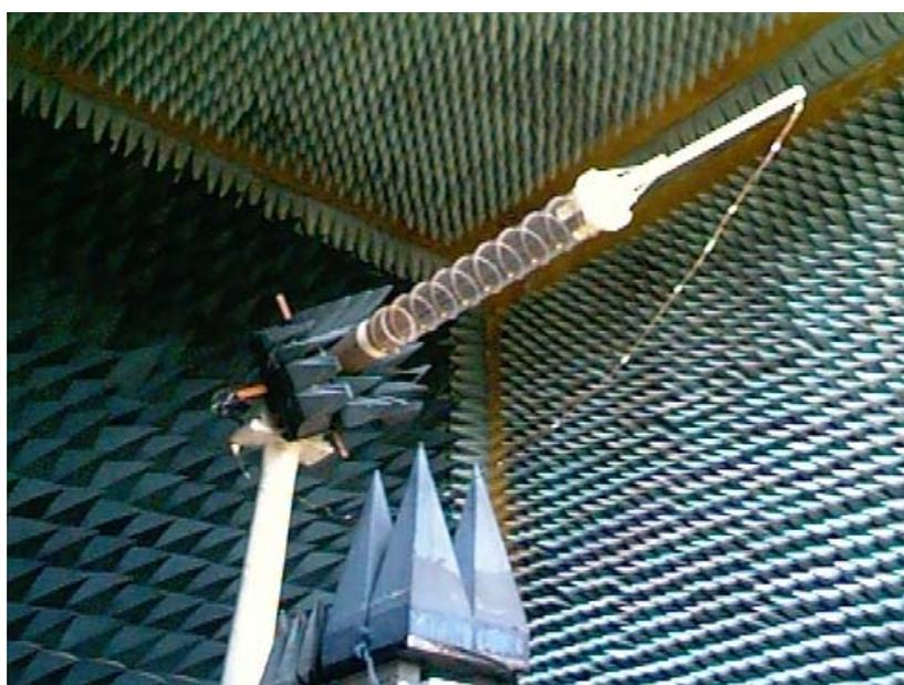
Figura 3.5 – Alimentador helicoidal do receptor de 408 MHz, na câmara anecóica do LIT no INPE de São José dos Campos. Um cilindro de material plástico é utilizado para sustentar o condutor enrolado helicoidalmente.
