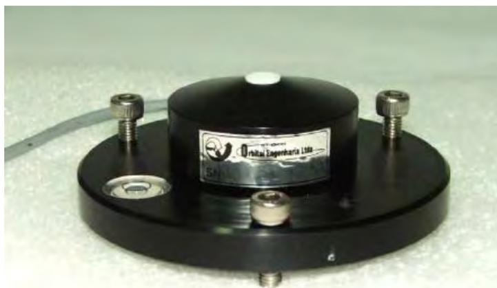
Figura 2.11 - Radiômetro fotovoltaico desenvolvido no LAS/INPE.
