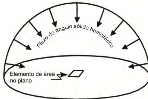
Figura 2.4 - Irradiância incidente de ângulo sólido hemisférico sobre um elemento de área.
