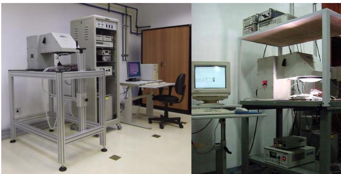
Figura 3.9 - Sistema, atual (esquerda) e antigo (direita), de medida de curva Corrente por tensão do CELSOL.
