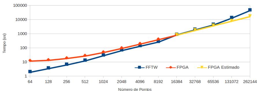
Figura 5.4 - Gráfico com os tempos das execuções da FFT usando a biblioteca FFTW e o coprocessador FFT (eixo vertical em escala logarítmica)
