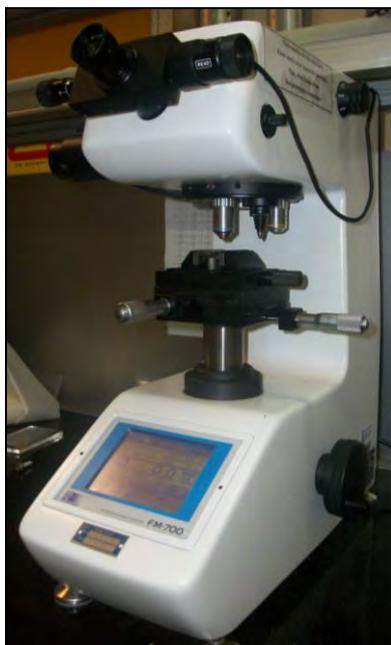
Figura 3.22 - Fotografia do microdurômetro localizado no IEAv.
