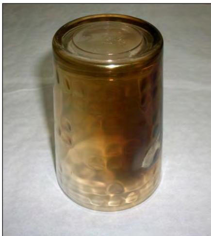
Figura 4.47 - Copo de vidro usado para apoiar o tubo nos experimentos N e O após o processo de deposição.
