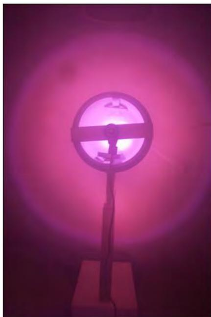
Figura 3.9 - Plasma de nitrogênio concentrado no interior do tubo. Observe que a fonte de descarga luminescente e o filamento de tungstênio estão desligados neste caso.
