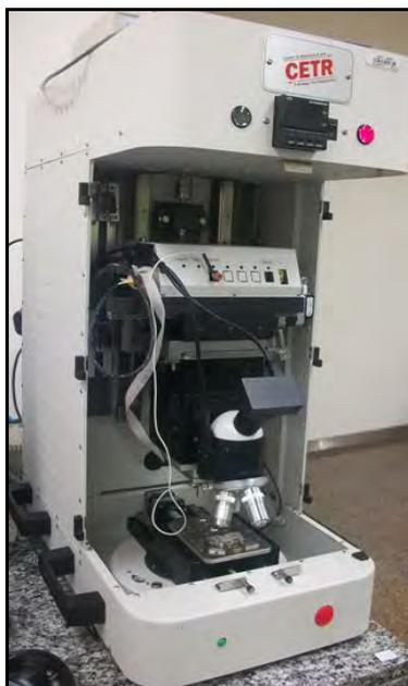
Figura 3.20 - Fotografia do tribômetro utilizado nos ensaios, localizado no Laboratório de Tribologia do grupo DIMARE.
