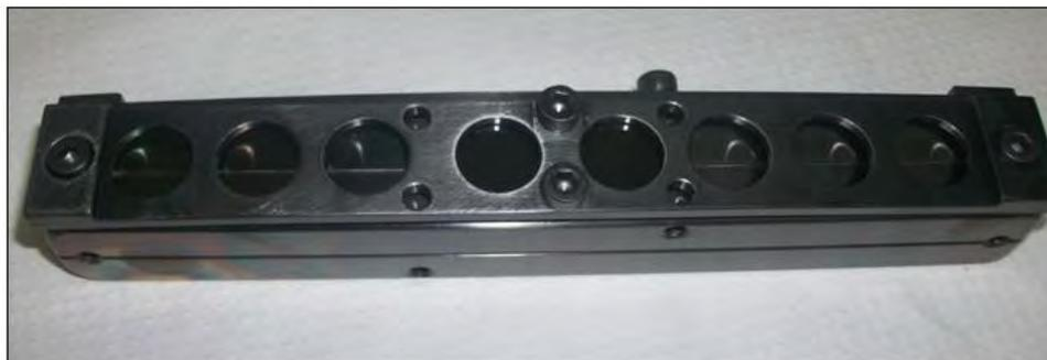
Figura 3.5 - Fotografia do porta-amostras para substrato plano após deposição de DLC.
