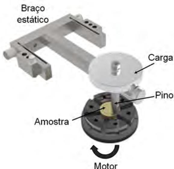
Figura 3.23 - Esquema simplificado do tribômetro.
