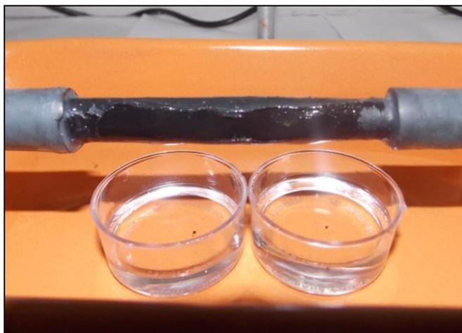
Figura 4.16 – Fotografia da membrana de VACNTs enrolada horizontalmente e utilizada no processo de filtragem entre água e óleo mineral.
