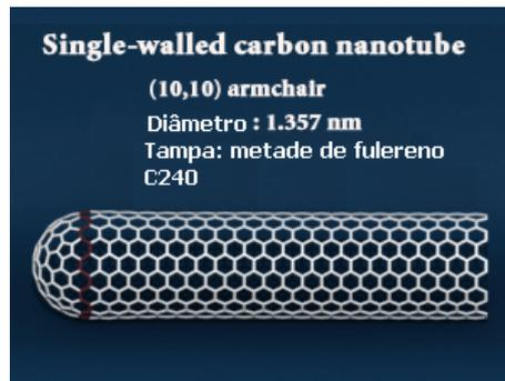
Figura 2.3 – *SWCNT* fechado em uma extremidade por um hemisfério fullerênico C240.
