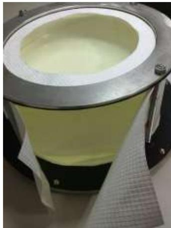
Figura 8.3 - Cintilador sendo envolto pela folha de Tyvek.
