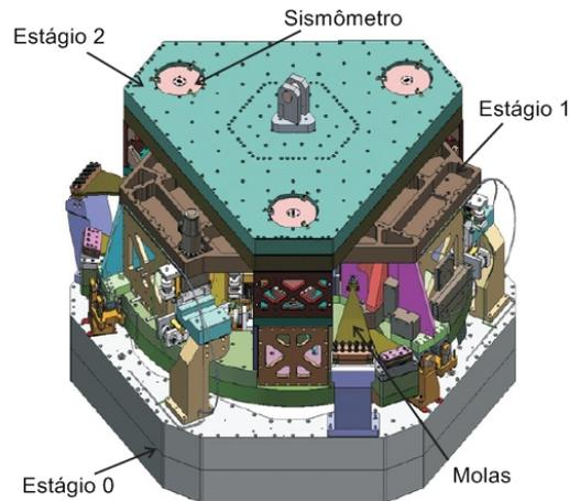
Figura 5.7 - Plataforma de isolamento ativo: subsistema de isolamento sísmico interno à câmara de vácuo. O estágio 0 é apoiado pelo subsistema externo. O estágio 1 é apoiado pelo estágio 0 através de lâminas de aço que funcionam como molas. E o estágio 2 é similarmente apoiado pelo estágio 1. Fonte: Adaptada de [Harry et al. \(2010\)](#).
