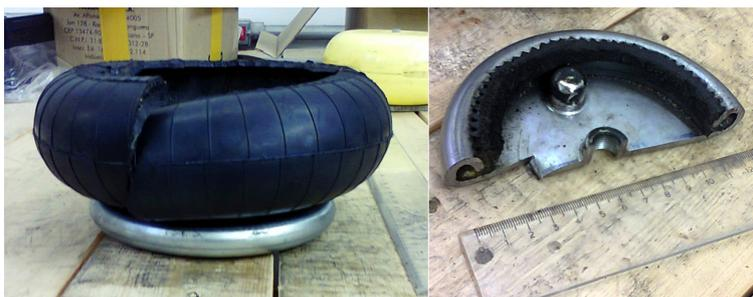
Figura 6.3 - À esquerda, fole cortado para ser retirado da tampa. À direita, tampa cortada com restante do fole queimado preso à mesma. A tampa tem uma borda curvada para encaixe do cabo de aço do fole.
