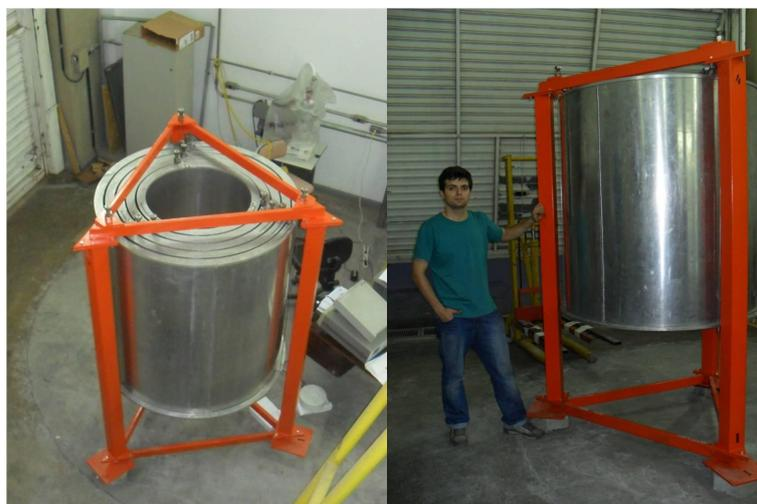
Figura 5.10 - *Multi-Nested Pendula* montando. À esquerda, visão superior do sistema. À direita é possível obter uma noção da altura do mesmo.
