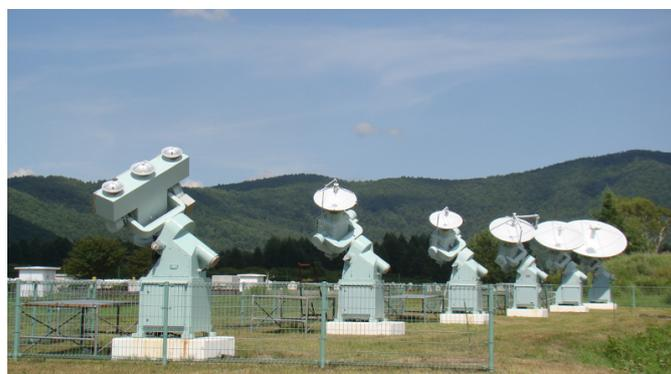
Figura A.1 - NoRP: da esquerda para a direita, antenas para 35 GHz e 80 GHz, 17 GHz, 9,4 GHz, 3,75 GHz, 2 GHz e 1 GHz.
