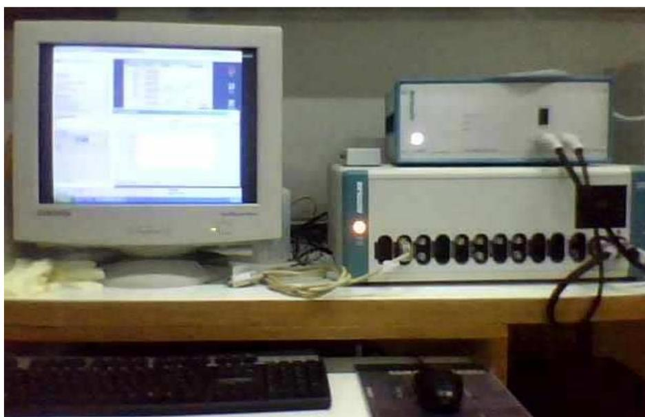
Figura 3.2: Potenciostato/galvanostato Metrohm, modelo Autolab – PGSTAT 302, conectado a um microcomputador.
