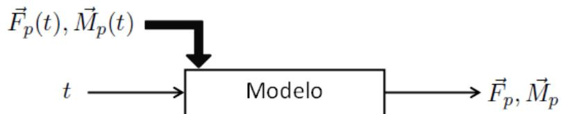
Figura 3.14 - Modelo do sistema propulsivo com força e momento conhecidos em função do tempo
