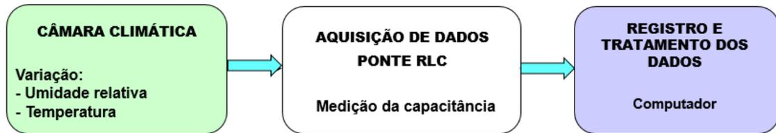
Figura 3.11 - Diagrama esquemático do sistema de caracterização elétrica dos sensores de umidade desenvolvidos neste trabalho.
