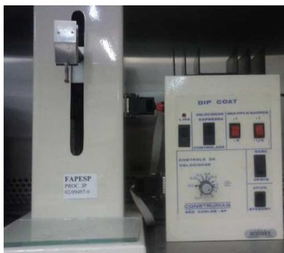
Figura 3.5 – *Dip coater* da marca Construmaq alocado no TECAMB/LAS/INPE.
