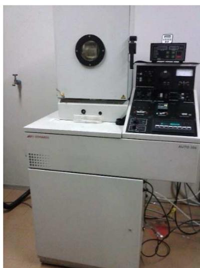
Figura 3.9 – Foto da evaporadora por feixe de elétrons onde foi realizada a deposição dos eletrodos dos elementos sensores desenvolvidos.
