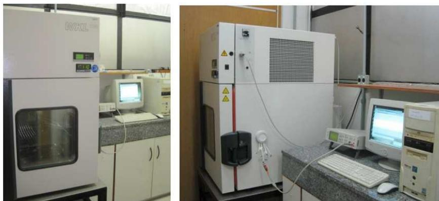
Figura 3.10 – Fotos da câmara climática conectada a uma ponte RCL utilizadas para as medições de capacitância dos elementos sensores em função da umidade do ar e da temperatura ambiente.
