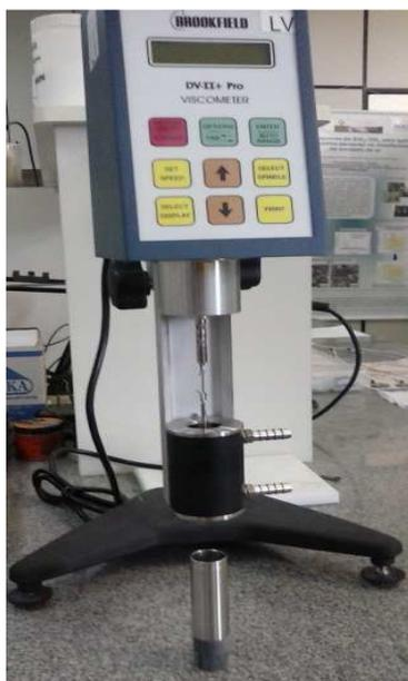
Figura 3.4 – Viscosímetro da marca Brookfield, modelo LV D-II + PRO.
