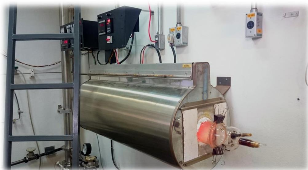
Inicialmente o forno foi ajustado para atingir 800 °C com fluxo de ar. Após estabilizado na temperatura desejada, as amostras foram inseridas, todas de uma só vez, o que provocou choque-térmico, mas sem haver trincas. Com 1 hora de recozimento, as amostras foram retiradas do forno e resfriadas em temperatura ambiente em menos de 1 minuto.
