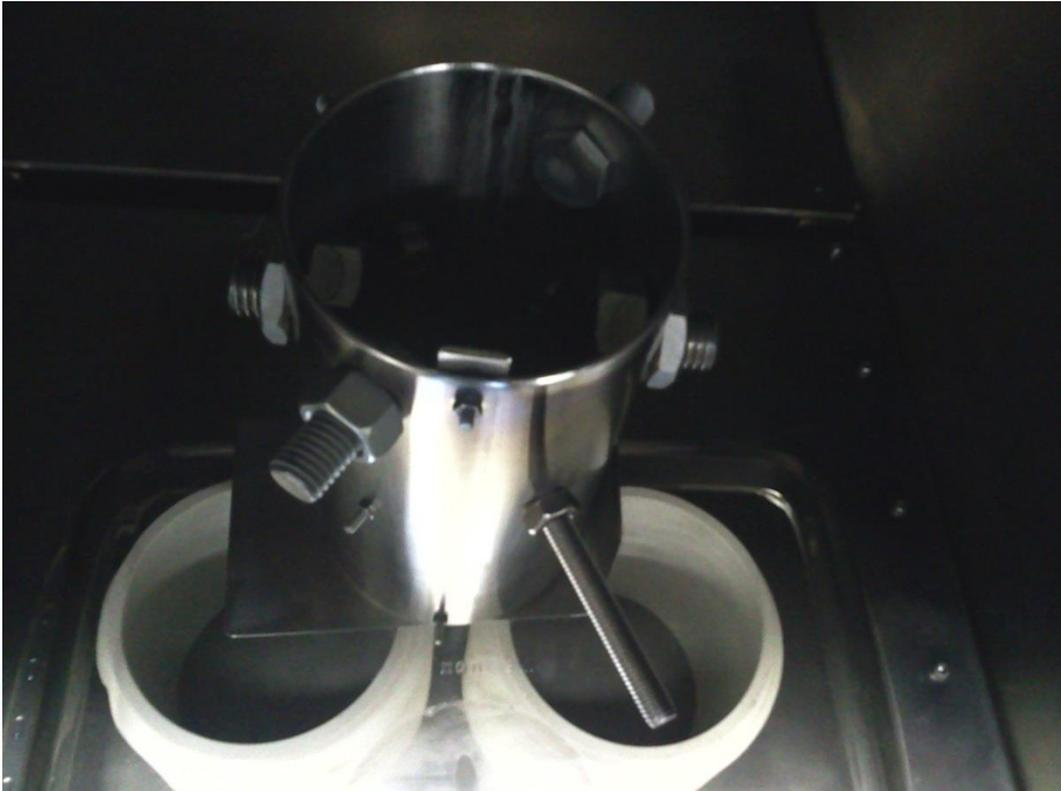
Os testes foram feitos com sucesso, com tratamento em lote, obtendo-se um plasma concentrado dentro do suporte tubular, e que pode ser visto pelo plasma que escapa pelo topo do suporte tubular mostrado na Figura 6.18.
