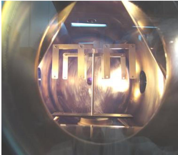
Figura 5.4. Manta de fibra de carbono exposta ao plasma e/ou 3IP de nitrogênio e/ou argônio para aumentar a aderência da superfície da fibra.
