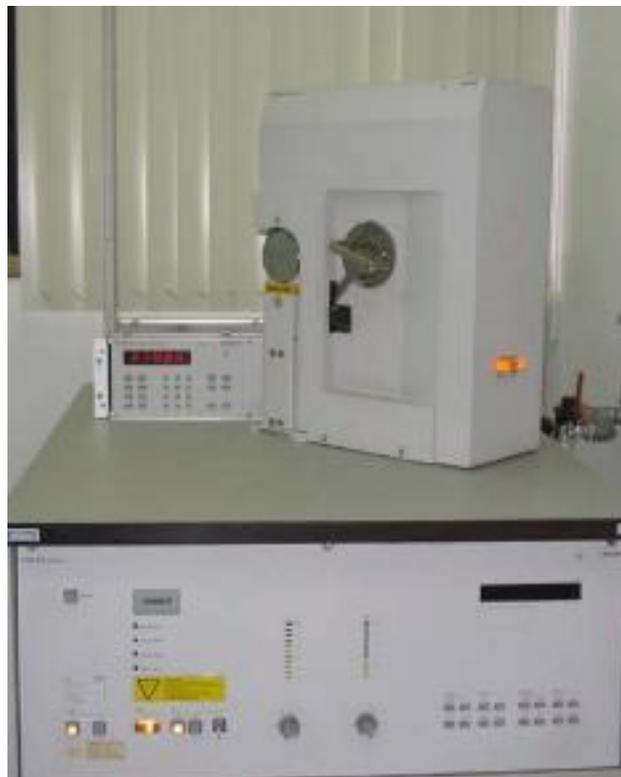
Os raios-X são uma forma de radiação eletromagnética que possuem elevadas energias e curtos comprimentos de onda (da ordem de magnitude dos espaçamentos atômicos nos sólidos). Quando um feixe de raios-X incide sobre um material sólido, uma fração deste feixe se dispersa, ou se espalha em todas as direções pelos elétrons associados a cada átomo ou íon que se encontra na trajetória do feixe. Considerando
