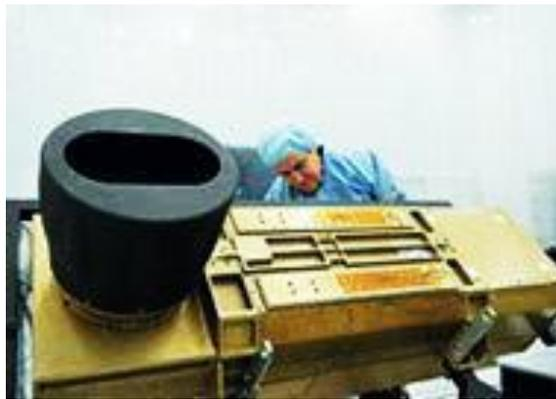
Por se tratar de implantação iônica, a geometria e a dimensão dos componentes após o processo de 3IP não sofre alterações significativas [10]. O método de tratamento por 3IP de nitrogênio foi o que apresentou melhores resultados nos testes práticos, sendo as peças tratadas por 3IP foram lançadas no último satélite (CBERS4).
