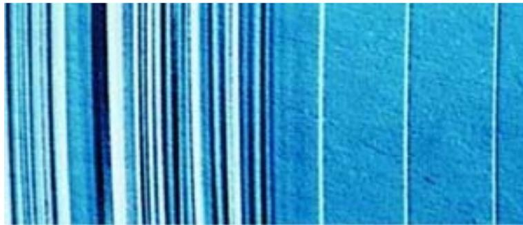
Esquerda: parte com estrias, crescido sob aceleração durante a decolagem do foguete; Direita: parte sem estrias, crescido em microgravidade.
